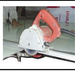
ตัดแผ่นตามขนาดที่ต้องการ cutting the panel as required size
